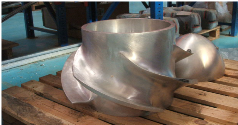
FIG. 3.4 : une photo réelle de l'hélice de la pompe démonté
