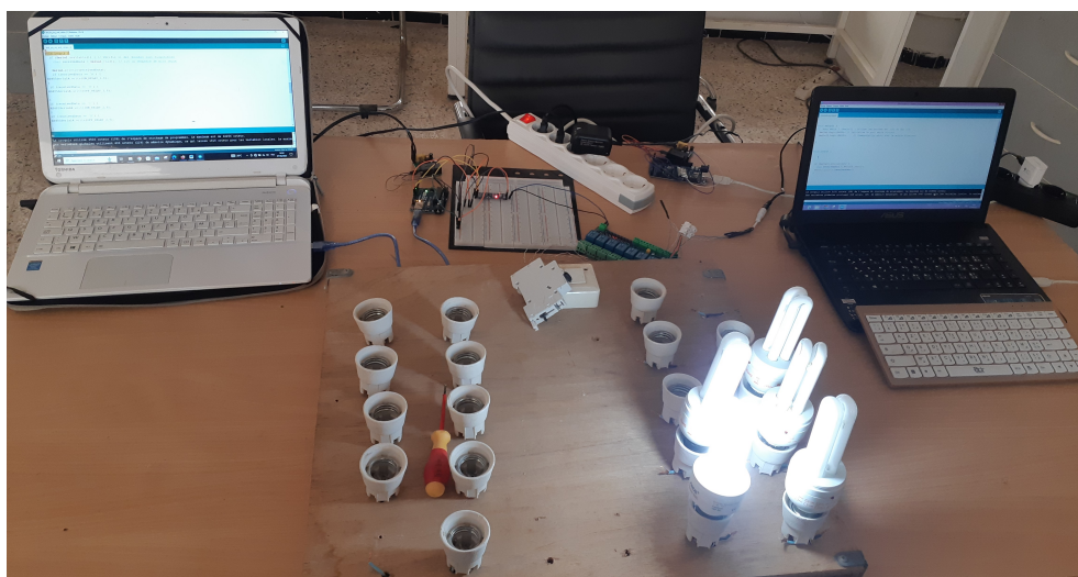
FIGURE III.17 – Système de commande d'éclairage par CPL. .
