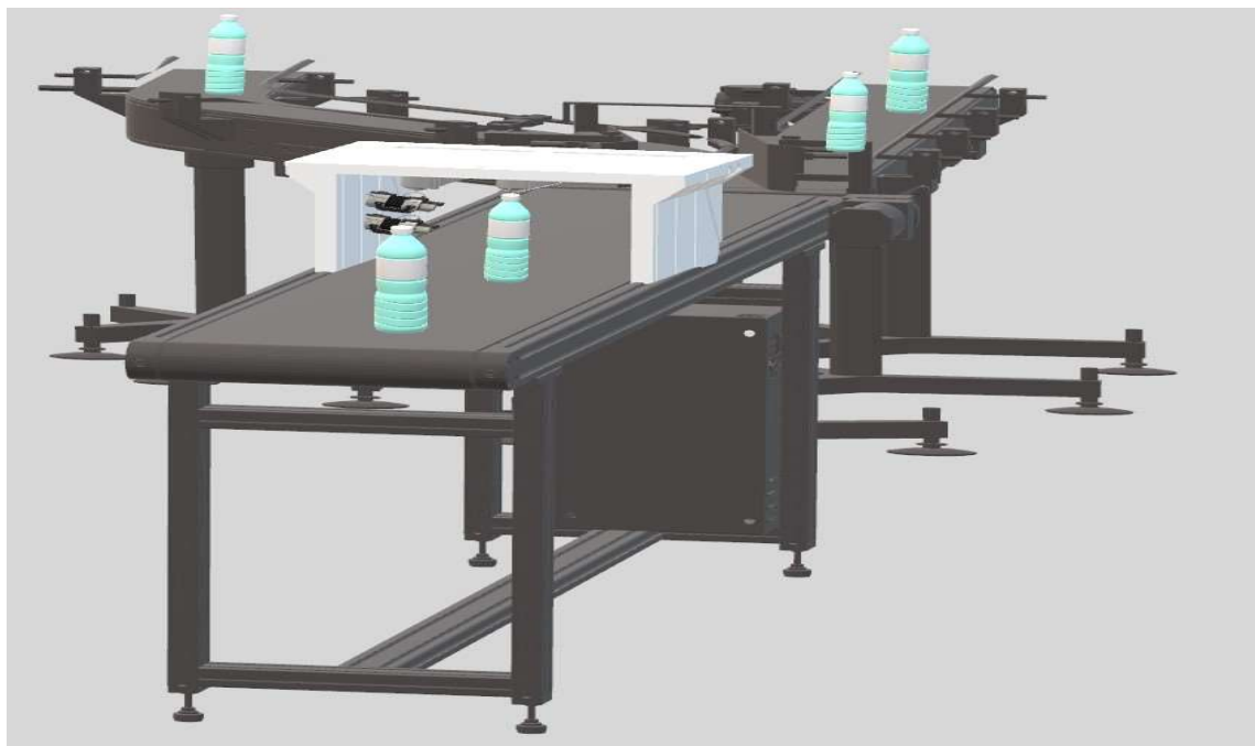
Figure IV.2 : La chaîne d'inspection
