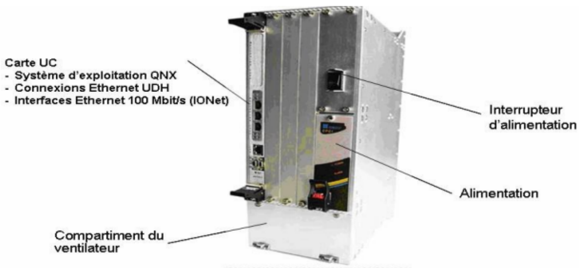
Figure 2.15: Le PCI du contrôleur Mark VIe [6]
