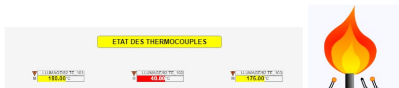
FIGURE IV.22: Illustration d'état défaut détecté par le thermocouple
