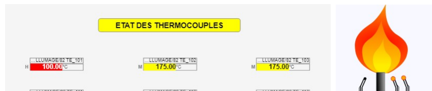
FIGURE IV.21: Illustration d'état défaut détecté par le thermocouple
