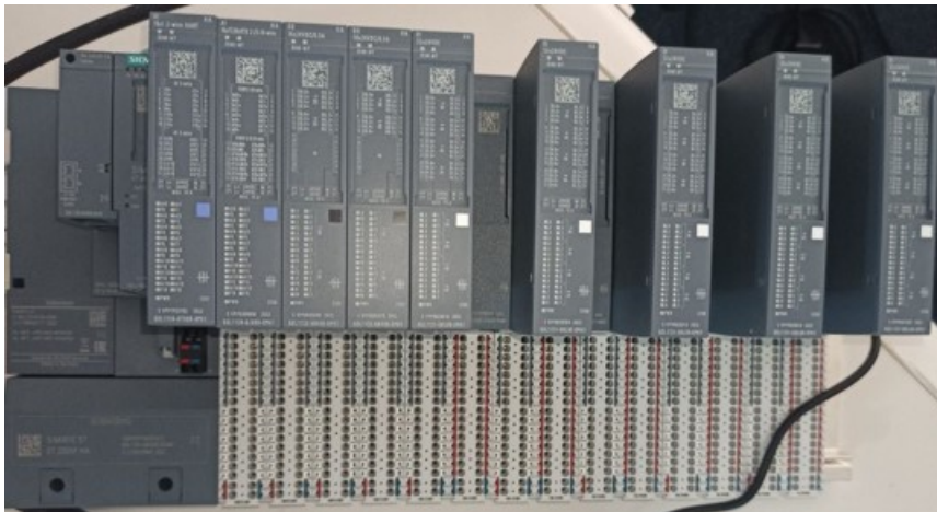
FIGURE II.2: Périphérique d'entrée sortie ET200SP HA
