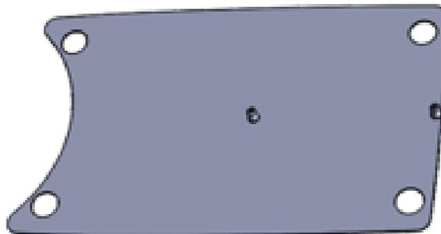
**Figure III-35 : Couvercle de socle.**
