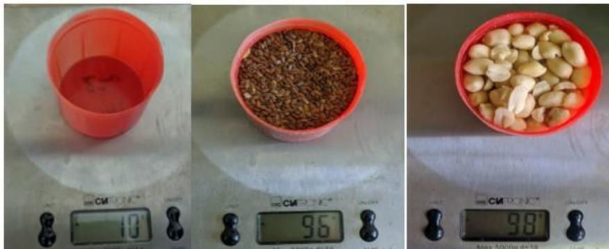
Figure III-23 : Exemple de calcul de volume massique de quelques types des grains.
