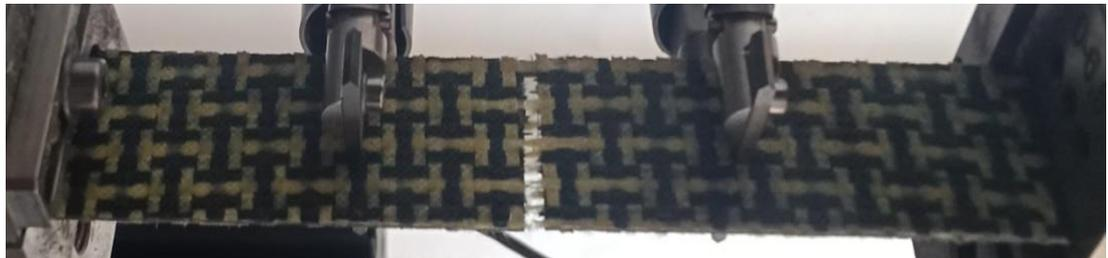
**Figure III-1:** La rupture de l'éprouvette de traction
