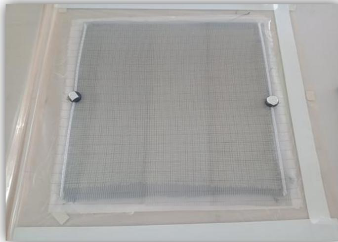
**Figure II-10:** Fermeture hermétique du sac à vide
