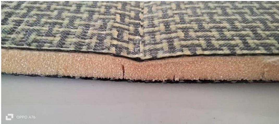
**Figure III-4:** Rupture de l'éprouvette de flexion
