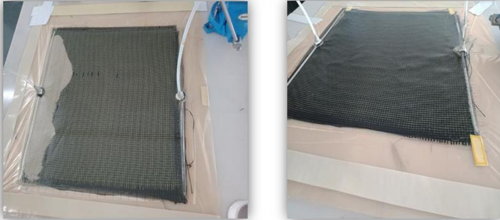
**Figure II-14:** Ecoulement de la résine
