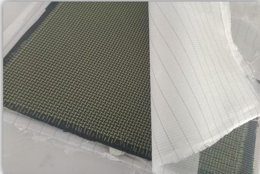
**Figure II-15:** Démoulage des stratifiés
