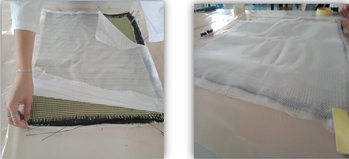
**Figure II-9:** Dépôt de l'ensemble (les fibres, le perforé et le tissu d'arrachage)
