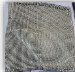
**Figure II-8:** Découpage les tissus de carbone et tissu hybride
