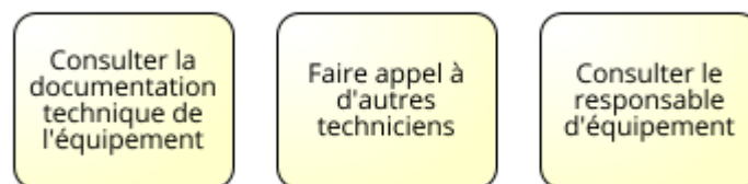
Figure 15 : Sous processus « effectuer un diagnostic » du processus de maintenance corrective proposé (Figure 16).
