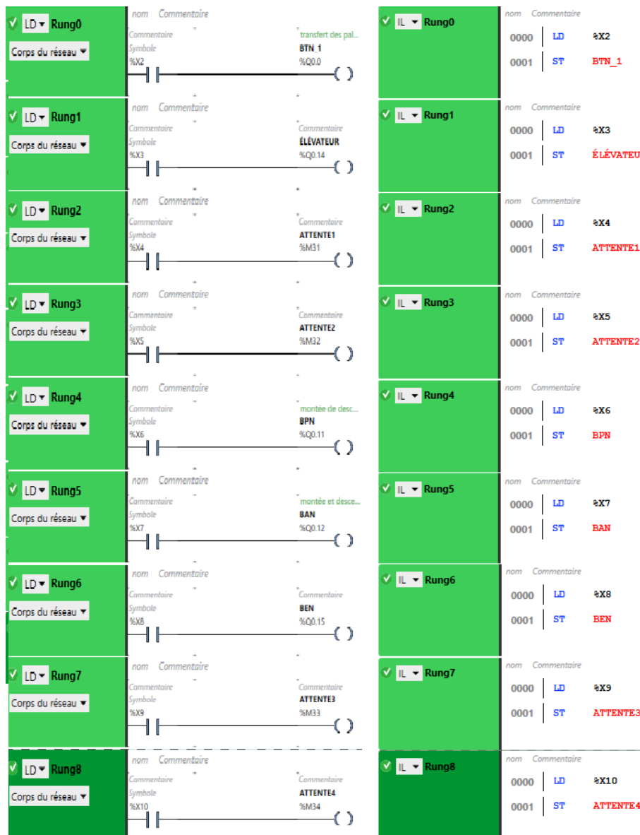
FIGURE 4.20 – Affection des sorties du Grafcet de coordination des tâches.
