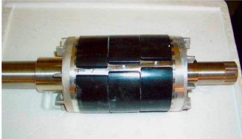
**Figure.1. 13** photographie d'un Rotor avec des aimants.
