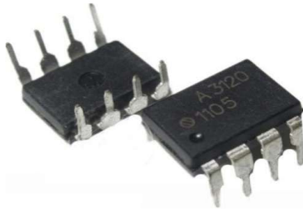
Figure III-12 : Circuit intégré Optocoupleur - Driver HCPL-3120 [6].
