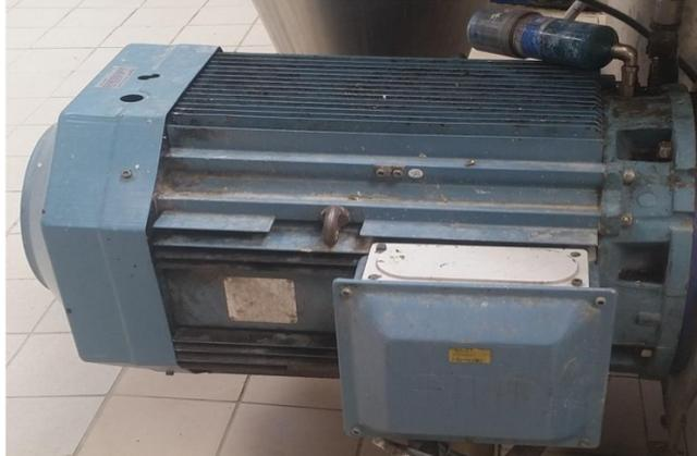
FIG. 1.6 : Moteur triphasé entraînant le séparateur.
