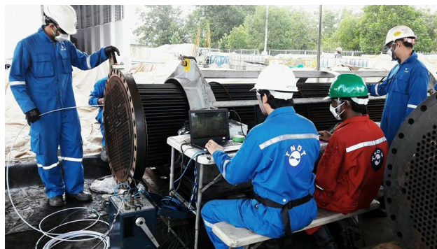
FIG. 1.2 – Fig : Inspection avec MFL
