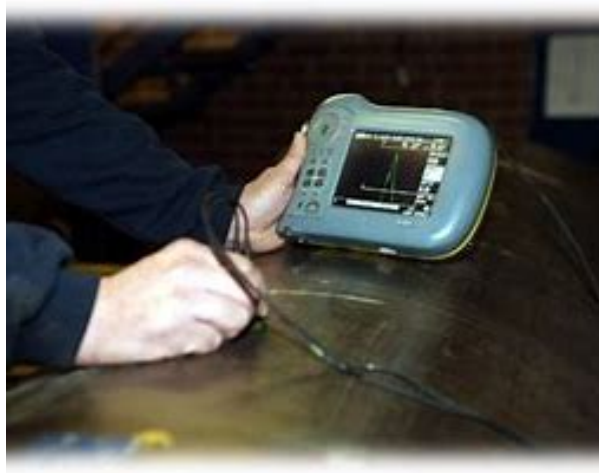
FIG. 1.1 – Fig : Inspection avec L'ultrason
