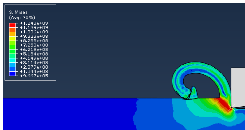
Fig. III.15 : distribution de Von Mises avec f=0.1\text{mm/tr} , V_c=100\text{ m/min} et \gamma=0 .
