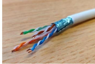
Figure 3.2 : Câble blindé avec une mince feuille d'aluminium ou feuillard FTP .
