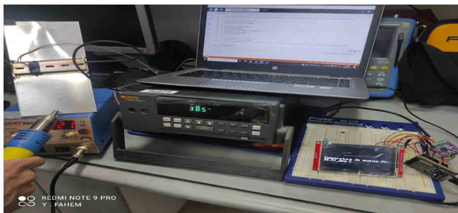
Figure 3.22 : Montage Expérimental pour la Validation des Mesures de Température du Module PV.
