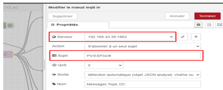
Figure 4.9 : Configuration de nœud 'mqtt in' sur Node-Red
