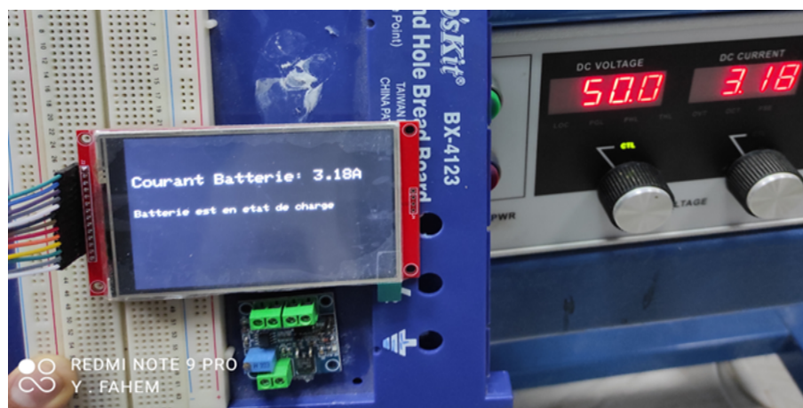
Figure 3.14 : Montage expérimental pour confirmer les relevés de courant de la batterie effectués par le circuit de mesure de courant de la batterie.
