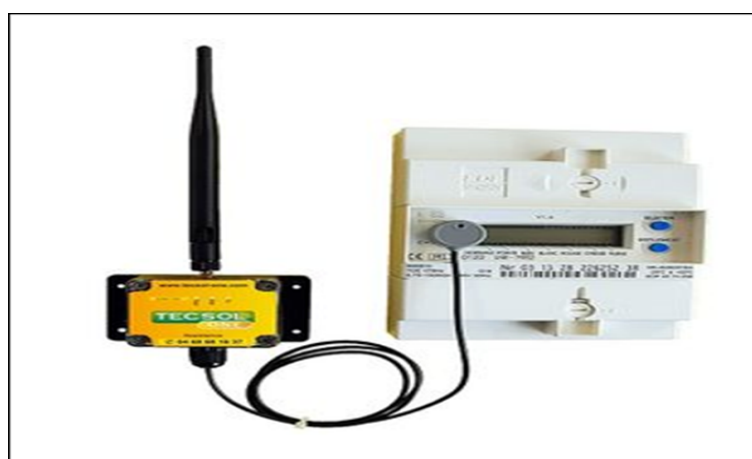
Figure 2.4 : Système de monitoring Tecsol-One connecté au compteur de production
