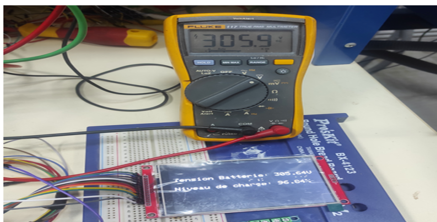
Figure 3.15 : Montage expérimental pour confirmer les relevés de Tension de la batterie effectués par le circuit de mesure de Tension de la batterie.
