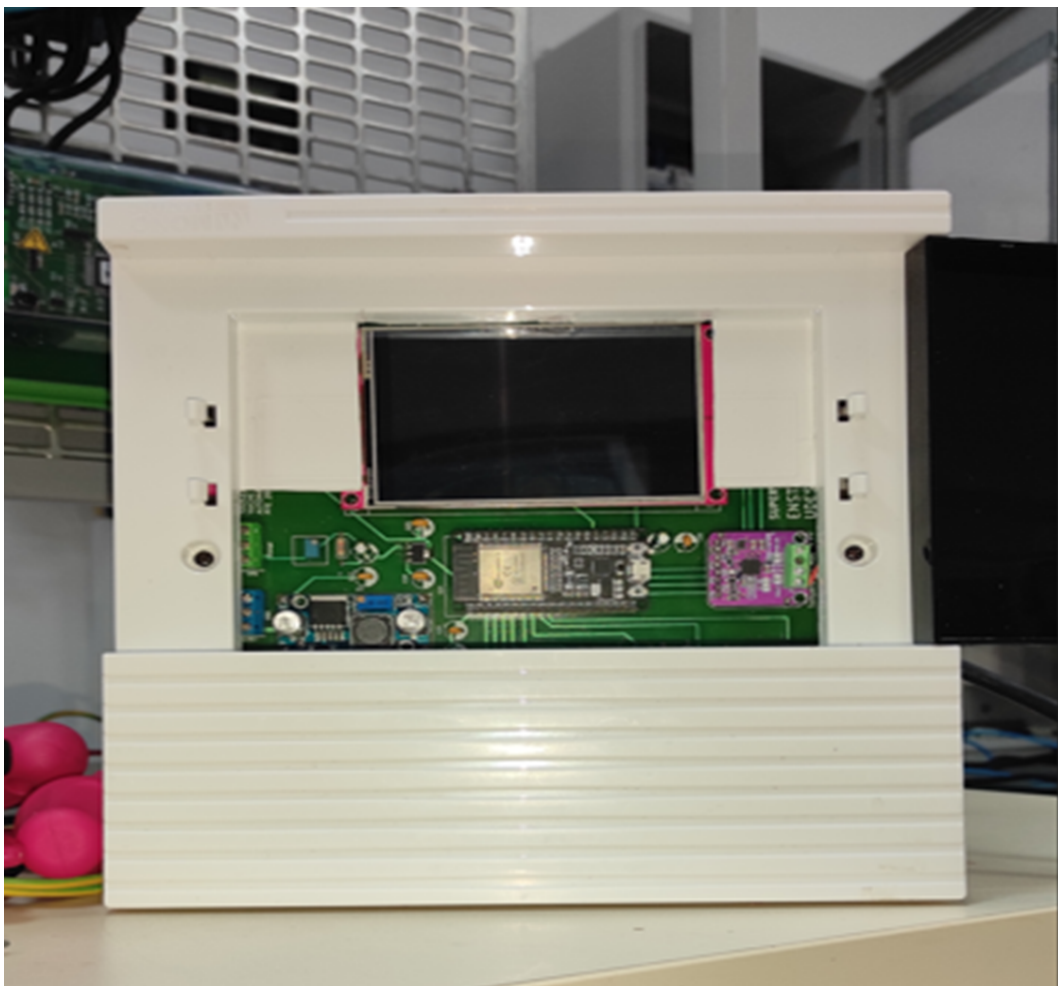
Figure 3.34 : Vue de face de notre système de monitoring conçu pour une installation PV
