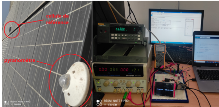
Figure 3.19 : Montage expérimental pour confirmer les relevés de l'irradiance effectués par la cellule de référence et le pyranomètre, disposés dans le même plan que les modules PV. L'un est relié au circuit de mesure connecté à l'ESP32 et l'autre est relié au datalogger
