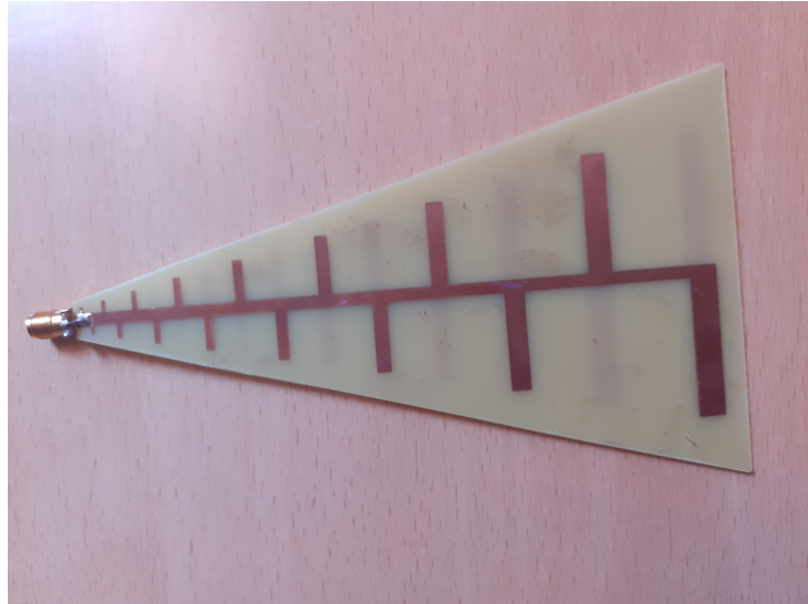
Figure 4.4 – PLPDA fonctionnant jusqu'à 7Ghz
