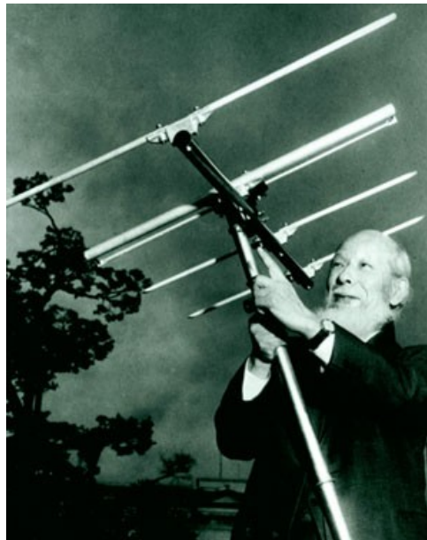
Figure 2.1 – Hidetsugu Yagi avec l'une des premières antennes que lui et Uda ont développées par Carrel et adoptée dans la littérature.
