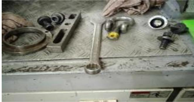
Figure 4. 12: Les outils utilisés pour le changement de moule.
