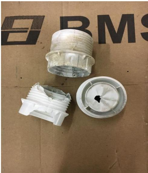
Figure 4. 25: Pièces non conforme de moule 113.
