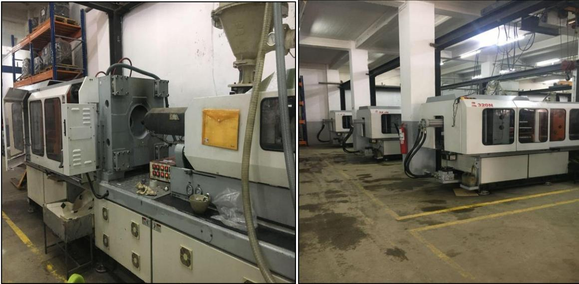
*Figure 4. 2 : Les machines d'injection thermoplastique*
