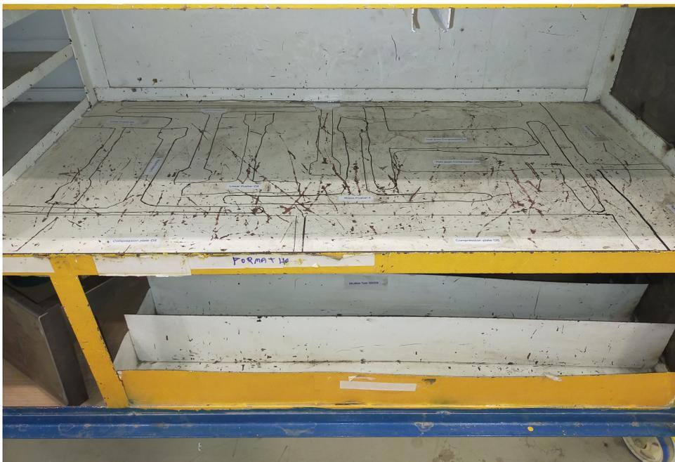
FIGURE 3.14 – Dessin des emplacements fixes des pièces
