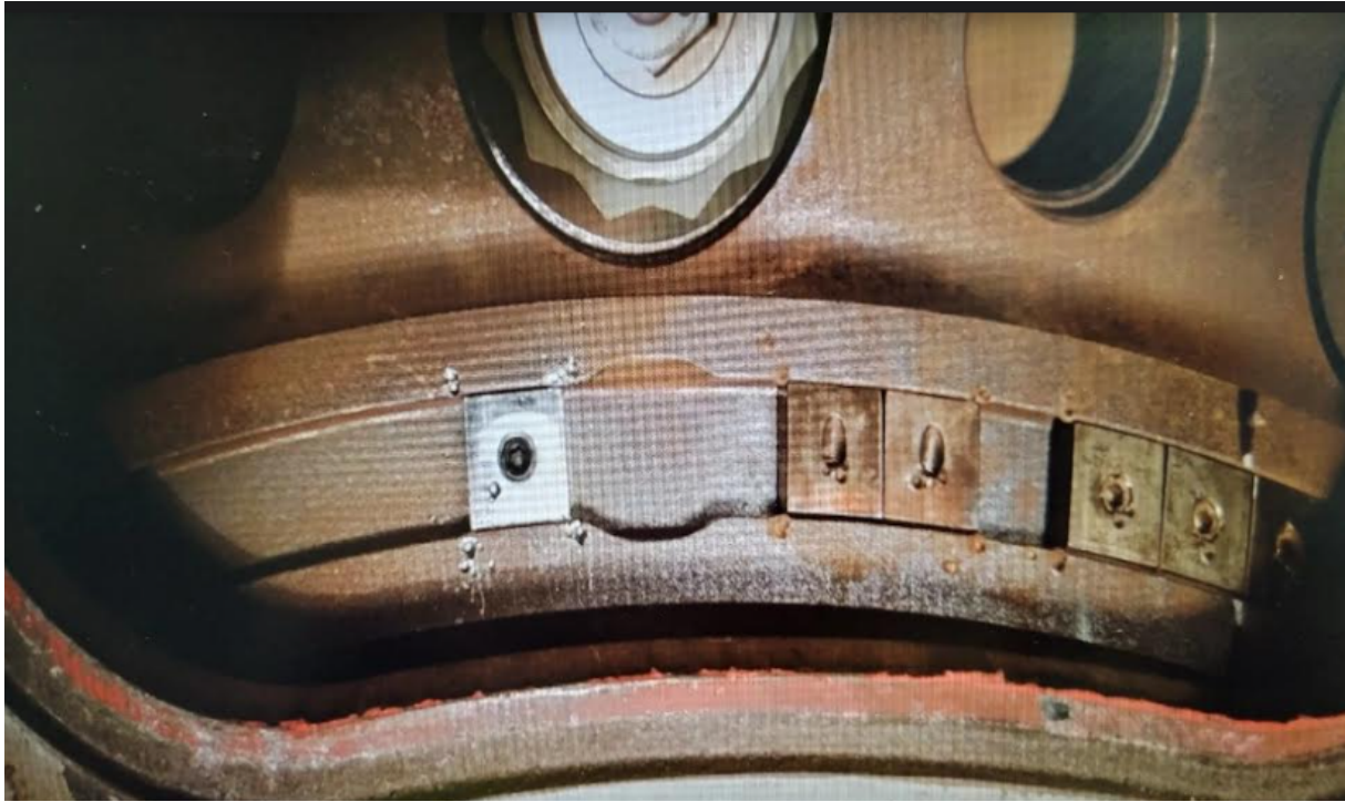
Figure 2.13: L'emplacement de la masse d'équilibrage sur une turbine à gaz .
