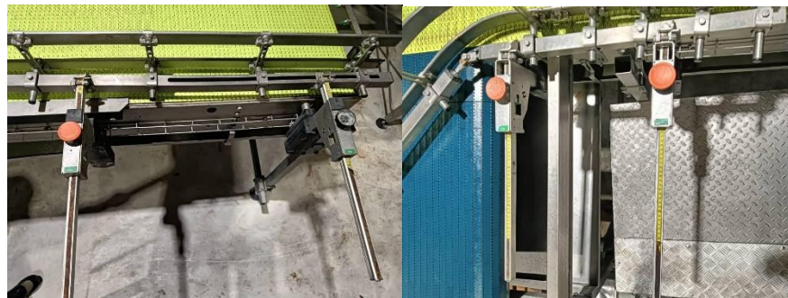
Figure 34 : Réglage des guides du convoyeur entrée bouteilles en ajustant les valeurs (A24, A25, A26, A27)
