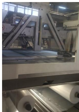
Figure 35 : Réglage de la hauteur de séparateur de caisse en ajustant la valeur F1
