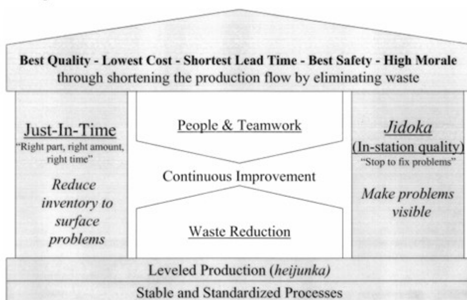
Fig. 1.1 – Maison du Lean [1]
