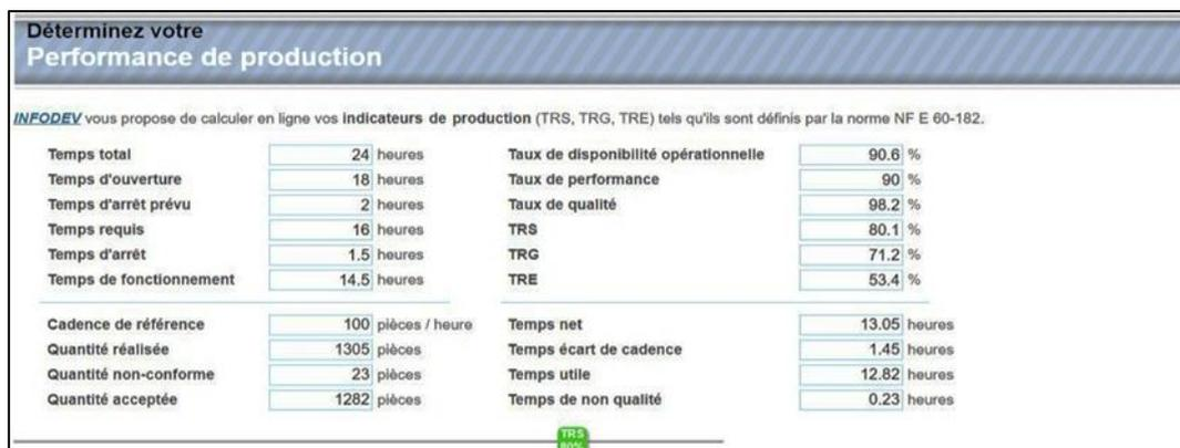
Figure 2: Exemple de calcul du TRS à l'aide de logiciel « infodev ».
