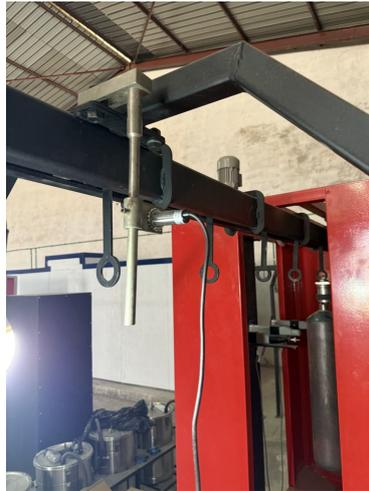
FIGURE 4.2 – Installation du capteur inductif de comptage sur le convoyeur.
