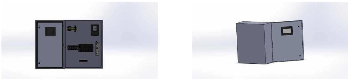
FIGURE 2.8 – Assemblage de l'armoire électrique – vues de face et latérale
