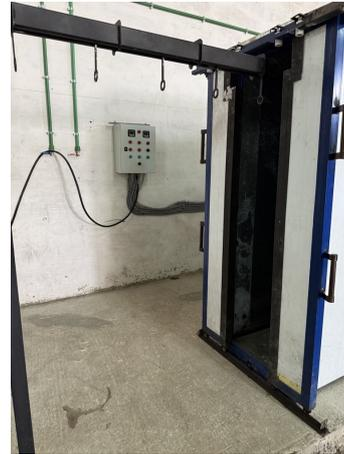
(b) Four avec son armoire de commande électrique.
