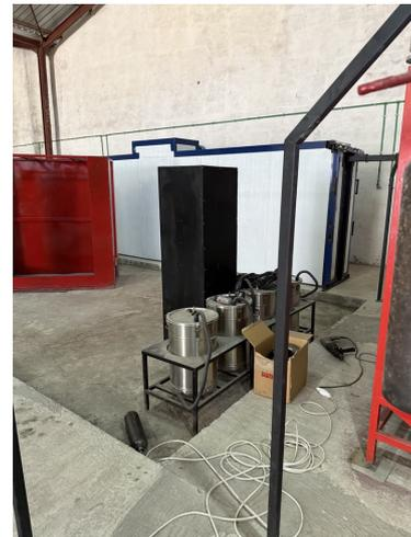
(b) Les quatre bidons de poudre installés dans l'atelier, connectés aux injecteurs.
