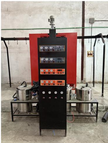
(a) Vue de l'armoire de commande du système d'injection de poudre.
