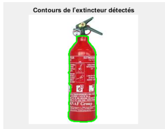
FIGURE 7 – Exemple réel de détection de contours de l'extincteur à l'aide de la segmentation binaire.
