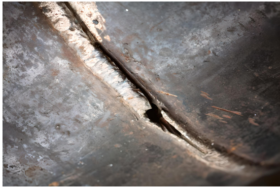
Figure 5: illustrations réelles de marquages par inclusions ou copeaux
