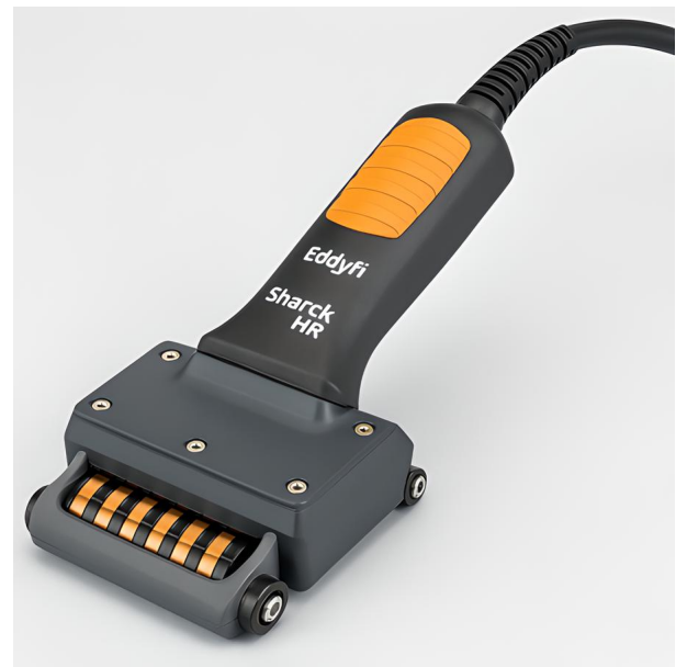
Figure 11: (b) Vue réelle d'un capteur Eddyfi Sharck HR inspectant une surface courbe
