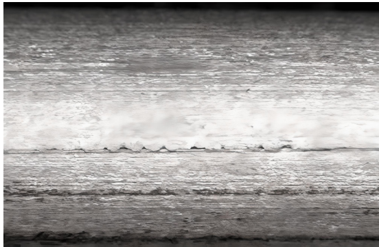
Figure 1: illustration réelle de défaut d'ondulation (waviness)
