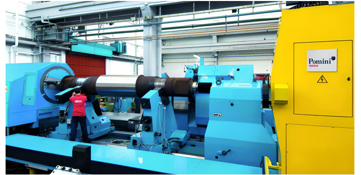
Figure 16: Machine de rectification CNC Pomini intégrée avec un système de contrôle PAUT
