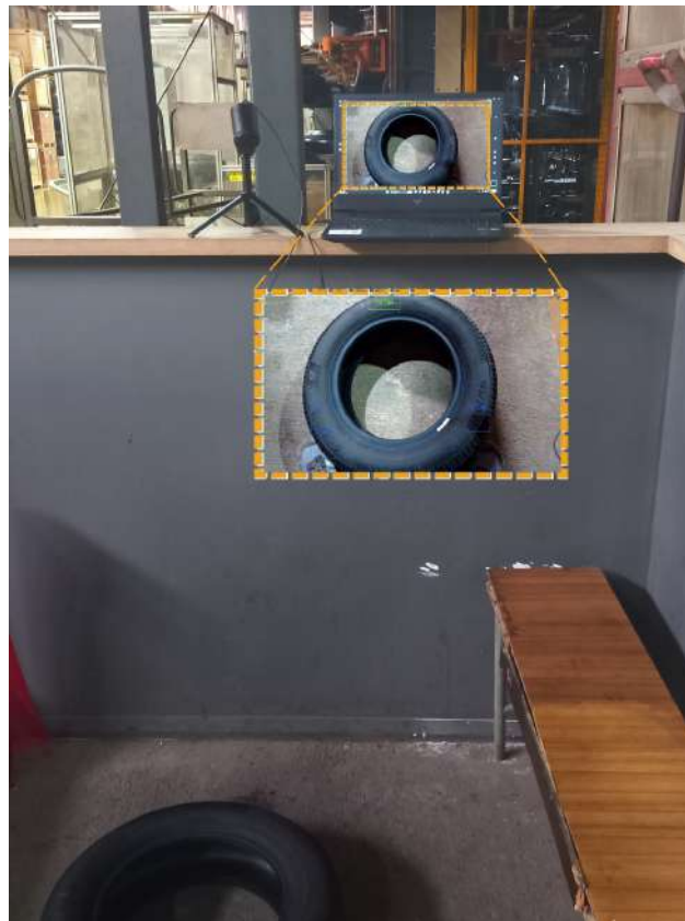
FIGURE 11. Scène réelle de détection de défauts sur pneu
