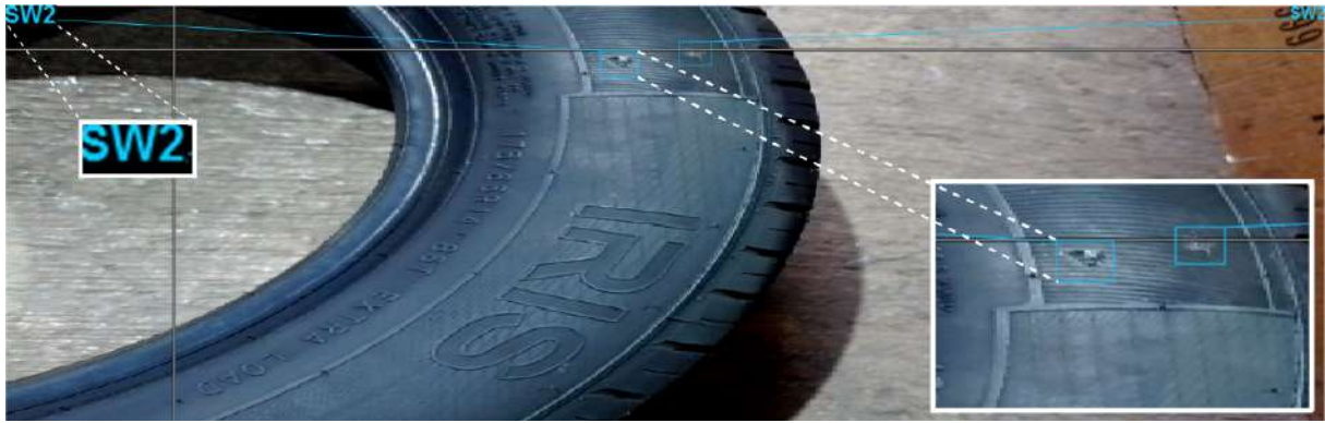
FIGURE 10. Détection automatique des fissures (SW2)
