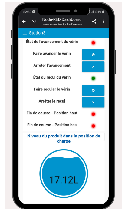
FIG. 14 : Interface de supervision de la Station3 (Contrôle qualité)
