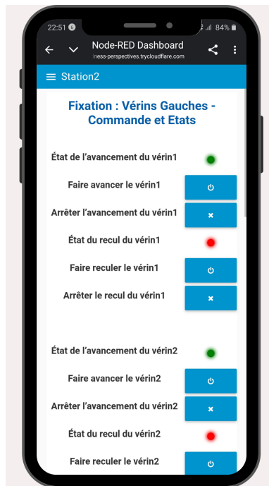
FIG. 13 : Interface de supervision de la Station2 (Découpage)
