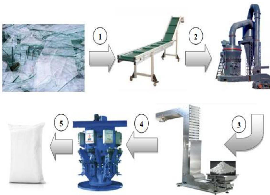
Figure III.21: processus de production « poudre de verre »
