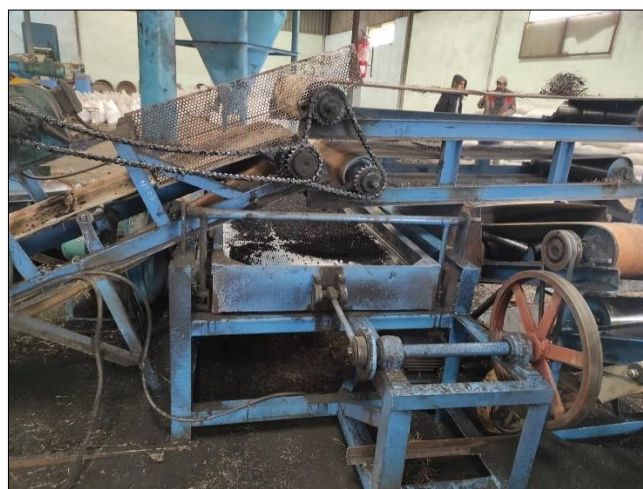
Figure 1-22 Séparateur de métal et tamis vibrant.
