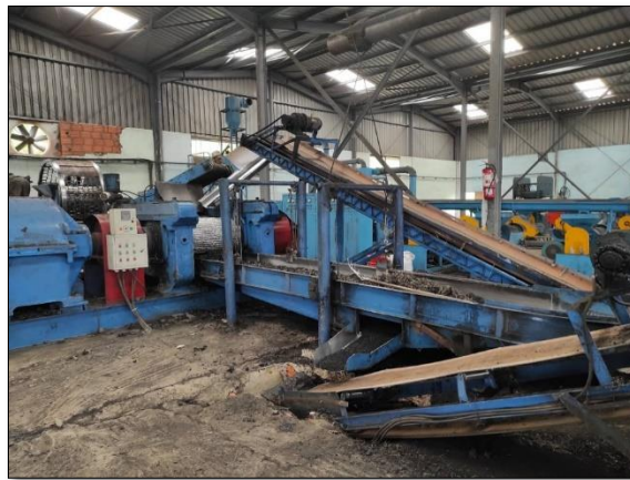
Figure 1-19 Convoyeur tamiseur du broyeur.
