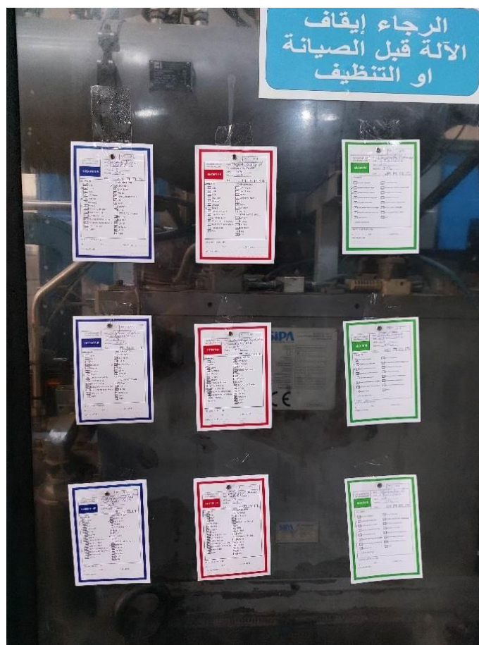
Figure 51: Tags des problèmes détectés durant le nettoyage
