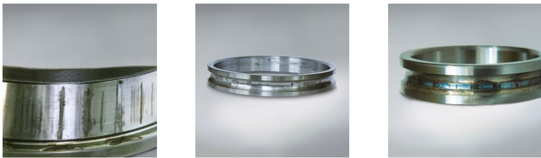
FIG. 1.10 : Exemples des défauts de roulement [7].
