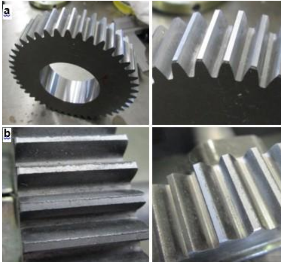
FIG. 2.2 : a) photos d'engrenage sans défaut. b) photos d'engrenage avec défaut [35].
