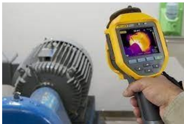
FIG. 1.8 : Technique de la thermographie infrarouge [4].
